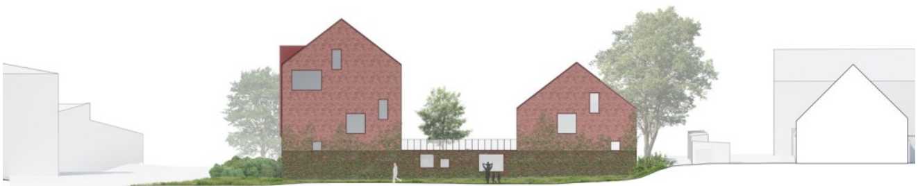
Figur 5. Østfacade, der vender mod grønning. Trods illustrationen giver udtryk for det, kan der ikke etableres vinduer i muren mod øst.
